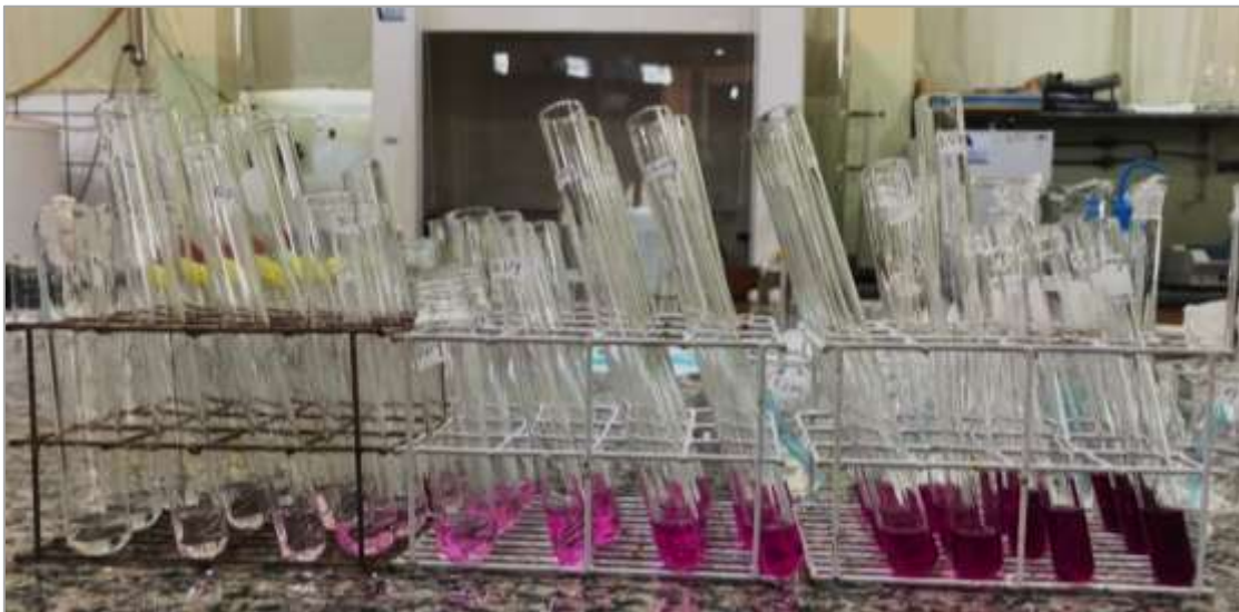
Figura 3 – Determinação do nutriente nitrito, em tubos de ensaio. Laboratório de Limnologia e Microbiologia – LABLIM, UNIR, Ji-Paraná, Rondônia. Setembro de 2018.
