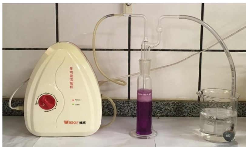
Figura 4 -Esquema representativo do conjunto gerador de ozônio e frasco lavador de gases.
