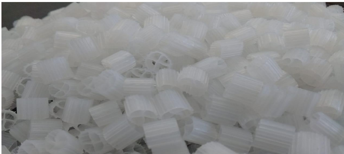
Figura 4 - Suportes Kaldnes K1 utilizados no sistema MBBR. Fonte: Arquivo próprio.
